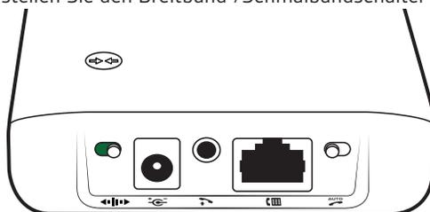
Stellen Sie den Schalter auf rot (Schmalband) für eine längere Lebensdauer des Akkus oder, um die Anzahl der in einem kleinen Bereich einsetzbaren Systeme zu erhöhen.
