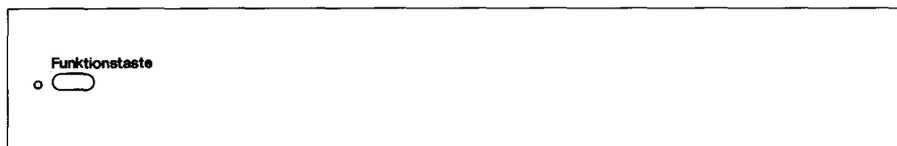
Drücken Sie die Funktionstaste »Rufumleitung«, - die Leuchtdiode der Taste erlischt. - Die Rufumleitung ist gelöscht.
